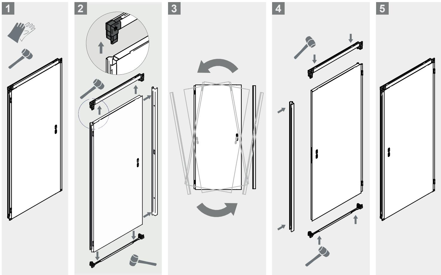
Instalación con garras / Anchor installation / Fixation par pattes de scellement / Instalação com garras
